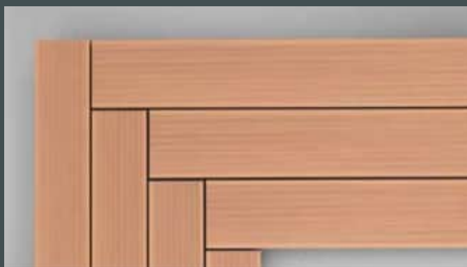
Соединение в край под прямым углом лесенкой
